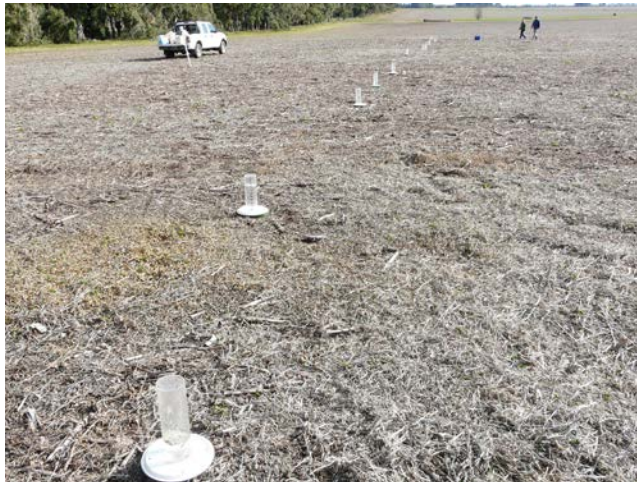
Foto 2. Vista de los infiltrómetros de anillo simple en todos los tratamientos del ensayo.
